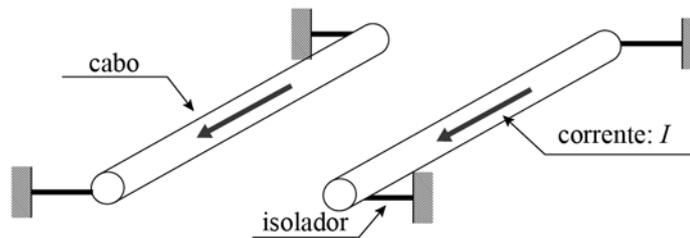
Um sistema de distribuição em corrente contínua contém um circuito com 2 cabos condutores rígidos idênticos ligados em paralelo, fixados por isoladores de borracha e posicionados conforme mostra a figura.
