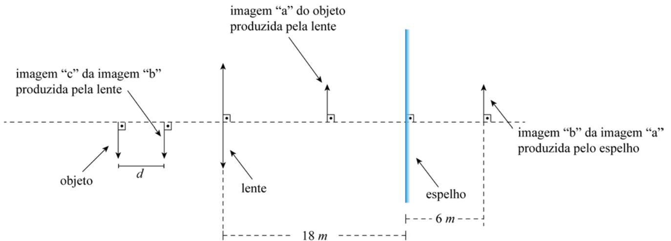
Um objeto encontra-se sobre o eixo central de uma lente convergente delgada, em algum ponto à esquerda da lente. A imagem desse objeto produzida pela lente está indicada na figura como imagem “a”. Um espelho plano reflete a imagem “a”, produzindo uma imagem “b”. Por sua vez, a imagem “b”, ao passar de volta pela lente, produz a imagem “c”.
