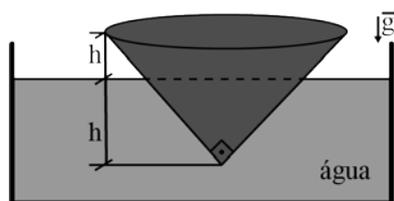
Um recipiente vazio de formato cônico está parcialmente imerso na água e em equilíbrio, como geometria apresentada na figura. Insere-se no interior do recipiente uma partícula de massa  $m = K\rho\pi h^3$ , onde  $K$  é uma constante,  $\rho$  é a massa específica da água e  $h$  está indicado na figura. Após essa inserção, o recipiente sofre um pequeno deslocamento, afundando uma altura  $\Delta h$ .
