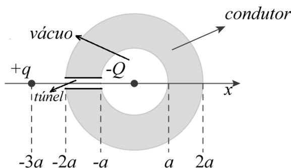
O arranjo da figura \u00e9 composto por uma casca esf\u00e9rica condutora oca de espessura  $a$  com uma part\u00edcula de carga negativa fixada em seu centro. A casca possui um t\u00fanel muito estreito em torno do eixo  $x$ , por onde uma part\u00edcula de carga positiva, inicialmente em repouso, pode atravess\u00e1-la.
