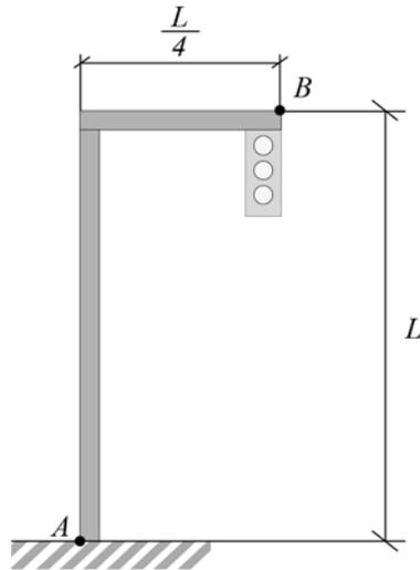
Inicialmente, um poste, fabricado com material de coeficiente de dilatação volumétrica  $\gamma$ , tem as dimensões indicadas na figura, estando o ponto A fixo. Ao ser submetido a um aumento de temperatura T, o ponto B é deslocado de:
