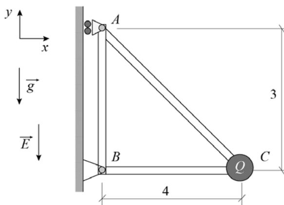
A figura apresenta uma estrutura formada pelas barras AB, BC e CA. Essa estrutura está apoiada na parede vertical nos pontos A e B. O apoio A permite reações apenas na direção do eixo x, enquanto o apoio B permite reações nas direções dos eixos x e y. Na extremidade C da estrutura está posicionada uma partícula de carga  $Q$  e massa  $M$ . A estrutura está em uma região do espaço submetida a um campo elétrico vertical de módulo  $E$  e sentido de cima para baixo.
