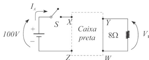
A caixa preta acima possui a associação de um indutor, um capacitor e um resistor. Inicialmente, a chave S está aberta e não há energia armazenada nos componentes. Em  $t = 0$  a chave S é fechada. Em  $t \rightarrow \infty$ , a corrente  $I_A = 10$  A e a tensão  $V_1 = 80$  V. Sabendo que a energia total armazenada nos campos magnético e eletrostático do circuito é 370 J, a alternativa correta que apresenta a topologia e os valores dos componentes na caixa preta é:
