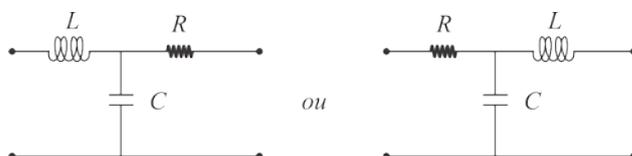
Para a condição do problema, a 1ª configuração fica invalidada, pois nesta situação teríamos o curto do indutor e a tensão sobre a resistência de  $8\Omega$  seria a mesma da fonte (100 V). A única situação possível dentre as alternativas, seria a letra D.
