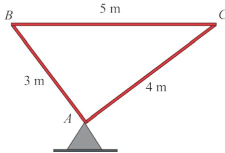
Três barras rígidas de aço  $AB$ ,  $BC$  e  $CA$  são montadas de modo a formar um triângulo pitagórico, conforme apresentado na figura. O sistema está apoiado em um pino no ponto  $A$  e o lado  $BC$  encontra-se alinhado com a direção horizontal. A densidade linear de massa das barras é  $\mu$  e a aceleração da gravidade é  $g$ . A força horizontal aplicada para manter o sistema em equilíbrio deverá ter:
