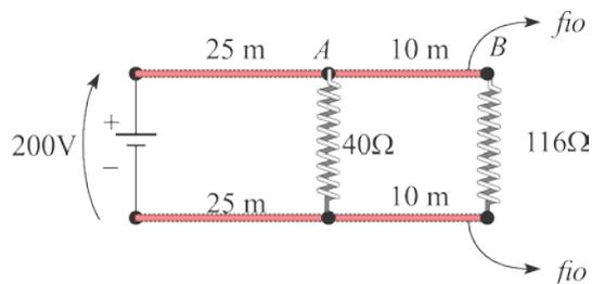
O circuito mostrado acima, emprega um fio de  $2 \text{ mm}^2$  de seção transversal e resistividade de  $0,4 \Omega \text{ mm}^2 / \text{m}$ . A diferença de potencial (*ddp*) entre os pontos A e B, em volts, é:
