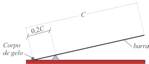
Um corpo de gelo está disposto na extremidade de uma gangorra que possui uma barra de comprimento  $C$ , cuja massa é uniformemente distribuída. Inicialmente, o sistema está em repouso, conforme mostra a figura acima. Em  $t = 0$ , o gelo é aquecido por um resistor de resistência  $R$ , percorrido por uma corrente elétrica contínua  $i$ .
