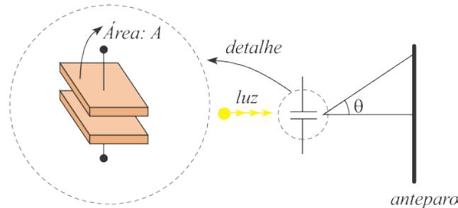
Na figura, ilustra-se um anteparo e um capacitor de placas paralelas cujo dielétrico é o ar. A luz de um laser incide no capacitor, paralelamente às placas. A figura de difração resultante é observada em um anteparo distante.
