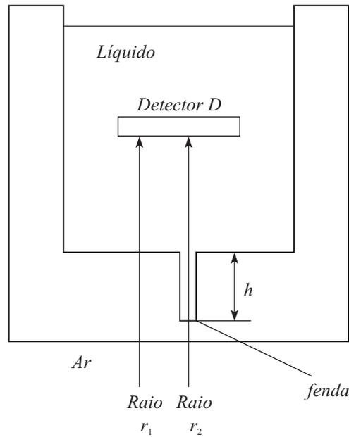
A Figura mostra dois raios luminosos  $r_1$  e  $r_2$ , de mesma frequência e inicialmente com diferença de fase  $\delta_1$ , ambos incidindo perpendicularmente em uma das paredes de um reservatório que contém líquido.
