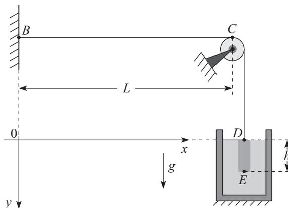
A figura acima mostra um corpo sólido cilíndrico de altura  $h$ , densidade  $\rho$  e área da base  $A$ , imerso em um líquido de mesma densidade em um tanque também cilíndrico com base interna de área  $4A$ . A partir do instante  $t = 0$  (situação da figura), o líquido passa a ser bombeado para fora do tanque a uma vazão variável dada por  $U(t) = bAt$ , onde  $b$  é uma constante positiva.
