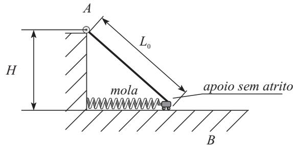
A figura acima mostra um sistema composto por uma parede vertical com altura  $H$ , uma barra com comprimento inicial  $L_0$  e uma mola. A barra está apoiada em uma superfície horizontal sem atrito e presa no ponto  $A$  por um vínculo, de forma que esta possa girar no plano da figura. A mola, inicialmente sem deformação, está conectada à parede vertical e à barra.
