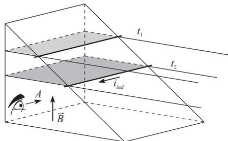
Considerando o campo magnético produzido pela bobina para cima, a lei de Faraday nos leva a uma corrente induzida no circuito fechado hachurado e a lei de Lenz nos leva a uma corrente induzida.
