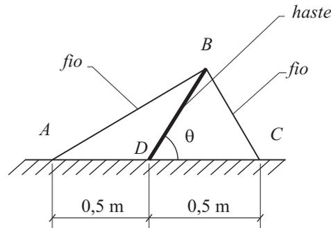
Um varal de roupas foi construído utilizando uma haste rígida  $DB$  de massa desprezível, com a extremidade  $D$  apoiada no solo e a  $B$  em um ponto de um fio  $ABC$  com 2,0 m de comprimento, 100 g de massa e tensionado de 15 N, como mostra a figura acima. As extremidades  $A$  e  $C$  do fio estão fixadas no solo, equidistantes de 0,5 m da extremidade  $D$  da haste.
