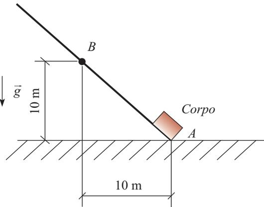
Um corpo com velocidade  $v$  parte do ponto  $A$ , sobe a rampa  $AB$  e atinge o repouso no ponto  $B$ . Sabe-se que existe atrito entre o corpo e a rampa e que a metade da energia dissipada pelo atrito é transferida ao corpo sob a forma de calor. Determine a variação volumétrica do corpo devido à sua dilatação.
