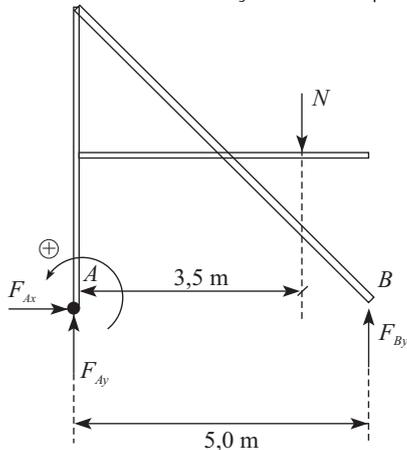
$N$  é a normal de contato entre a estrutura e o bloco, como o bloco está em equilíbrio:
