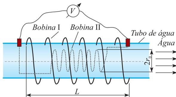
Considere a figura acima. A bobina I, com  $N_1$  espiras, corrente  $i$  e comprimento  $L$ , gera um campo magnético constante na região da bobina II. Devido à variação da temperatura da água que passa no cano, surge uma tensão induzida na bobina II com  $N_2$  espiras e raio inicial  $r_0$ . Determine a tensão induzida na bobina II medida pelo voltímetro da figura.
