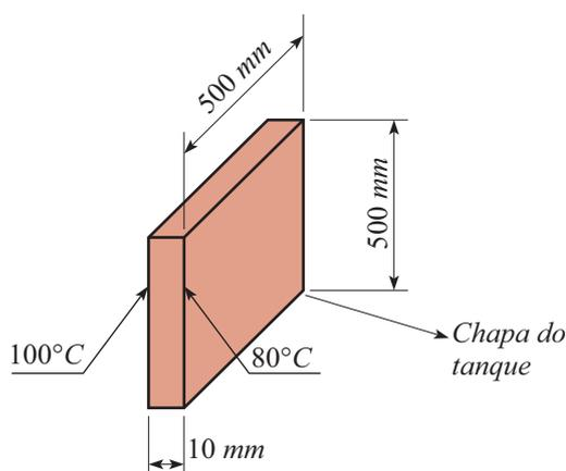
**Experiência 2:** A chapa da experiência anterior é posta em contato com uma chapa padrão de mesma área de seção reta e espessura  $210\text{ mm}$ . Nota-se que, submetendo este conjunto a 50% da taxa de calor empregada no tratamento do resíduo, a temperatura da face livre da chapa padrão é  $60^{\circ}\text{C}$  enquanto que a face livre da chapa da experiência atinge  $100^{\circ}\text{C}$ .
