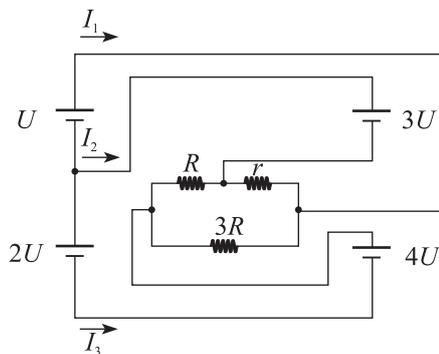
A figura acima apresenta um circuito composto por quatro baterias e três resistores. Sabendo-se que  $I_1$  é igual a  $10\frac{U}{R}$ ,
