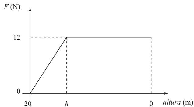
Um objeto com massa de 1kg é largado de altura de 20m e atinge o solo com velocidade de 10m/s. Sabe-se que a força  $F$  de resistência do ar que atua sobre o objeto varia com a altura, conforme o gráfico acima. Considerando que  $g = 10\text{m/s}^2$ , a altura  $h$ , em metros, em que a força de resistência do ar passa a ser constante é
