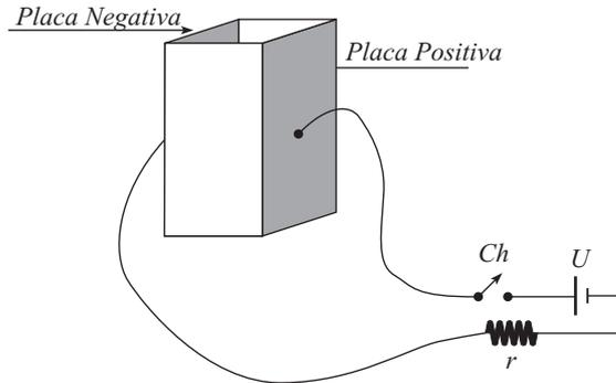
Um reservatório possui duas faces metálicas que se comportam como placas de um capacitor paralelo. Ao ligar a chave  $Ch$ , com o reservatório vazio, o capacitor fica com uma carga  $Q_1$  e com uma capacitância  $C_1$ . Ao repetir a experiência com o reservatório totalmente cheio com um determinado líquido, a carga passa a ser  $Q_2$  e a capacitância  $C_2$ . Se a relação  $Q_1/Q_2$  é  $0,5$ , a capacitância no momento em que o líquido preenche metade do reservatório é
