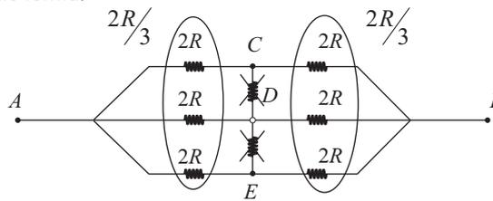
Onde, pela simetria,  $U_{AC} = U_{CB}$ ,  $U_{AD} = U_{DB}$ ,  $U_{AE} = U_{EB}$ .
