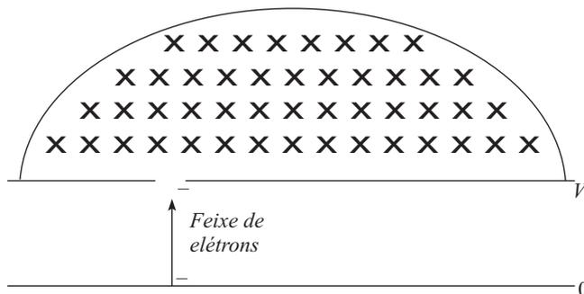
Um feixe de elétrons passa por um equipamento composto por duas placas paralelas, com uma abertura na direção do feixe, e penetra em uma região onde existe um campo magnético constante. Entre as placas existe uma d.d.p. igual a  $V$  e o campo magnético é perpendicular ao plano da figura.
