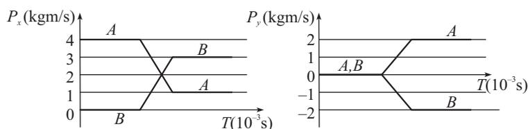
Das partículas A e B de massas  $m_A = 0,1\text{kg}$  e  $m_B = 0,2\text{kg}$  sofrem colisão não frontal. As componentes  $x$  e  $y$  do vetor quantidade de movimento em função do tempo são apresentadas nos gráficos acima.
